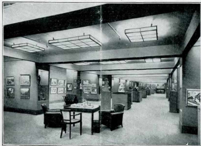
FIG. 4. — GALERIE D'ART DES MAGASINS DU BON MARCHÉ Eclairage général poussé. Les loges sont munies de rampes pour l'éclairage des tableaux.
